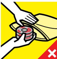
Cuando manipule las piezas metálicas, use siempre guantes limpios y secos para evitar dejar huellas dactilares y ácido úrico causantes corrosión.
