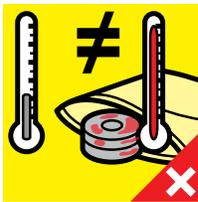
Al empaque asegúrese que la temperatura de las piezas metálicas sea la misma que la del lugar o cuarto, esto es para evitar la condensación.
