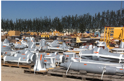
Artículos Metalicos Grandes envueltos en Película Termoretráctil de Preservación en Exteriores VCI
