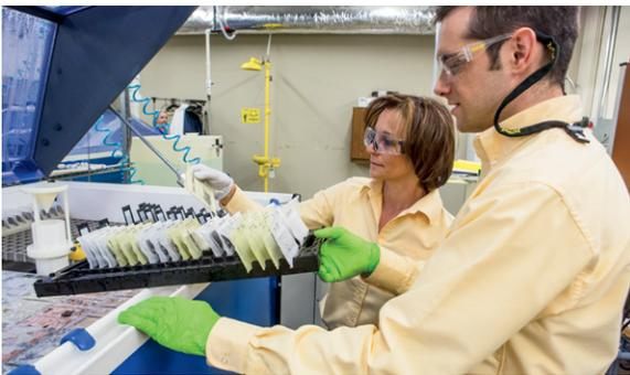
Utilizamos cámaras de humedad para hacer pruebas, para evaluar los procesos de fluidos de nuestros clientes, así como evaluar la eficacia de las soluciones anticorrosivas recomendadas.
