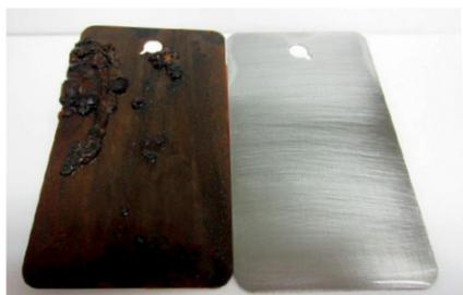
A la izquierda; sumergido en agua no tratada (60 ppm Cl<sup>-</sup>, 300 ppm CaCO<sub>3</sub>), a la derecha; sumergido en agua tratada con AxxaVis™ HST-10
