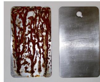
A la izquierda: Recubrimiento de aceite VCI de la competencia; a la derecha Aceite ZERUST® Axxanol™ 750 VCI. Resultados después de 24 horas en prueba de cámara salina ASTM B117.
