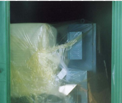
Una caja eléctrica protegida internamente por ZERUST® ICT® Cápsulas de Vapor y externamente por ZERUST® ICT®510-C Película
