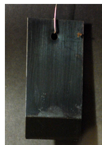
Panel metálico sin protección en un ambiente de gas de ácido sulfúrico H 2 S (2-18 ppm)
