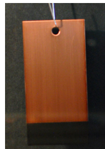
Panel metálico protegido con ActivPak® en un ambiente de gas de ácido sulfúrico H 2 S (2-18 ppm)
